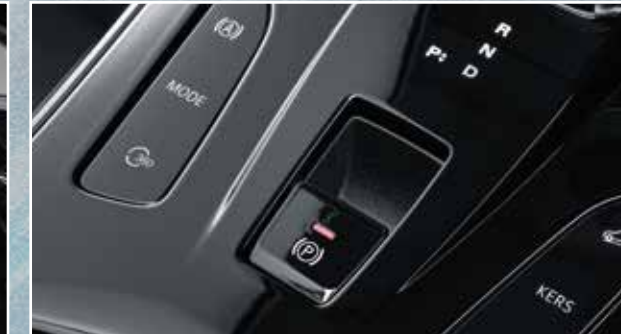
ระบบเบรกมือไฟฟ้า EPB และระบบป้องกันการไหลของรถ โดยไม่ต้องเหยียบเบรกค้าง AVH
